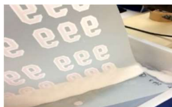
Hotmelt-Applikation auf Transferbogen Hotmelt application on transfer sheet
